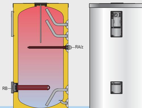
Résistance électrique sur les modèles CORAL VITRO SIMPLE PAROI, modèles ACCUMULATION et SERPENTIN
