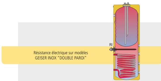
Résistance électrique sur modèles GEISER INOX "DOUBLE PAROI"
