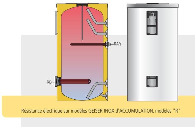
Résistance électrique sur modèles GEISER INOX d'ACCUMULATION, modèles "R"
