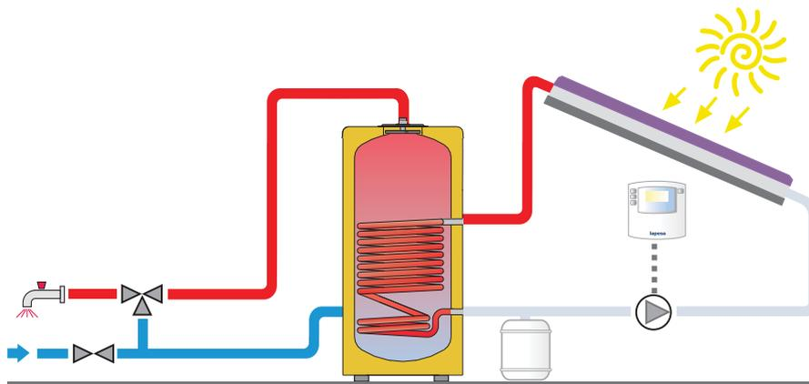
Schéma de principe d'une installation solaire thermique d'ECS à circulation forcée.
