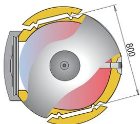
Détail de l'isolation prédecoupée des ballons de 800 et 1000 litres, pour passer des portes de 800 mm de largeur.
