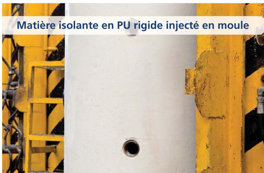
**Matière isolante en PU rigide injecté en moule**
