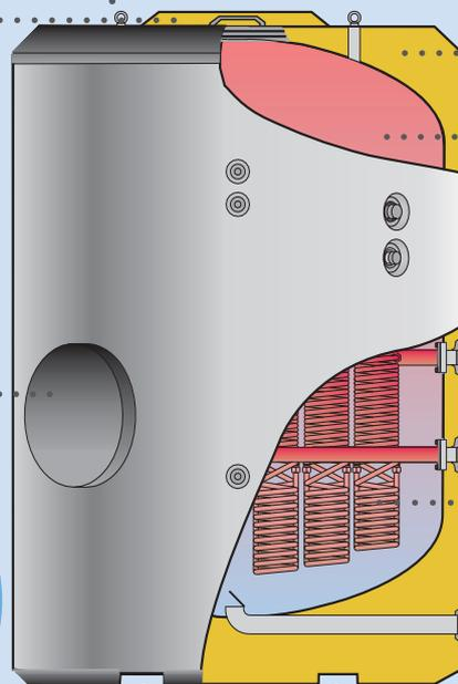
**Isolation PU rigide recouvrant l'ensemble du ballon.**
