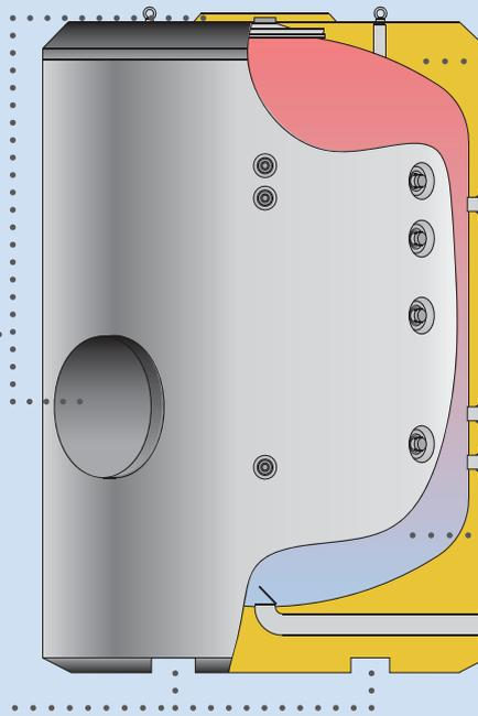
**Isolation PU rigide recouvrant l'ensemble du ballon.**
