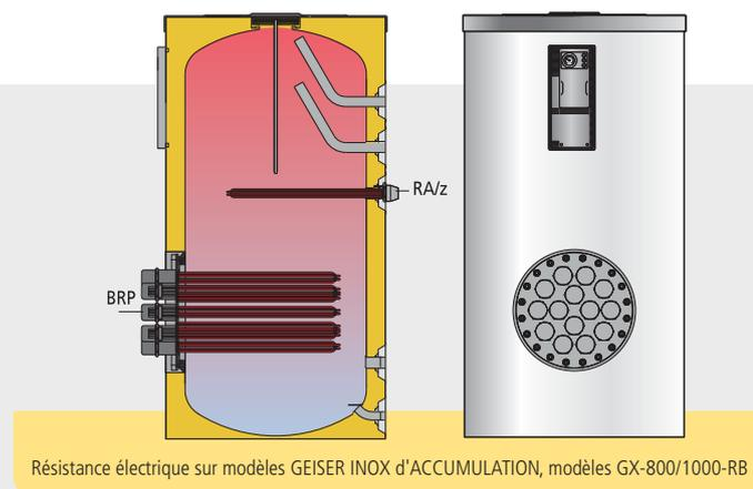
Résistance électrique sur modèles GEISER INOX d'ACCUMULATION, modèles GX-800/1000-RB
