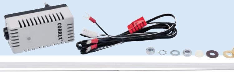
Protection cathodique permanente "lapesa correx-up": Équipement de protection cathodique permanente qui ne demande pas de maintenance. Ces anodes ne subissent pas d'usure et émettent le courant nécessaire automatiquement pour la protection cathodique du ballon, au travers d'un potentiostat individuel par anode, raccordé au courant électrique.
