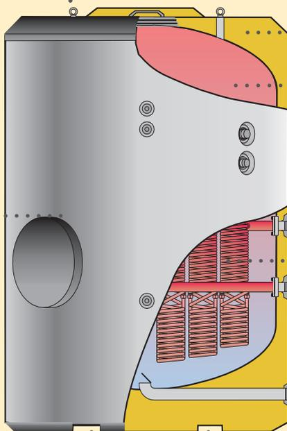
**Isolation PU rigide recouvrant l'ensemble du ballon**
